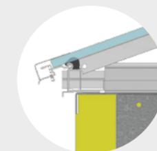
Arcothermprofil: rundumlaufendes Dichtungskammersystem zur wesentlichen Reduktion der Kondensatbildung
