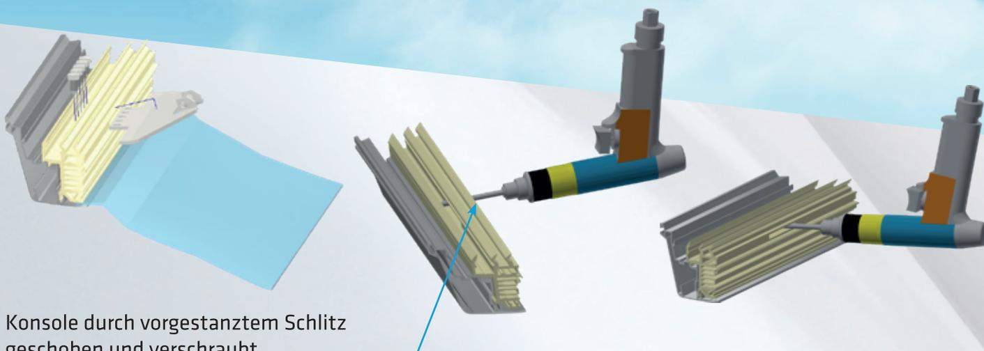
Konsole durch vorgestanztem Schlitz geschoben und verschraubt
